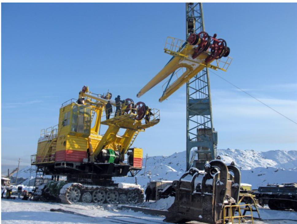
Рис. 1. Специалистами ремонтно-монтажного комплекса компании «ОМЗ-Гортехмаш» был закончен восстановительный ремонт экскаватора ЭКГ-8И для ОАО «Коршуновский ГОК» (ОАО «Мечел»)
